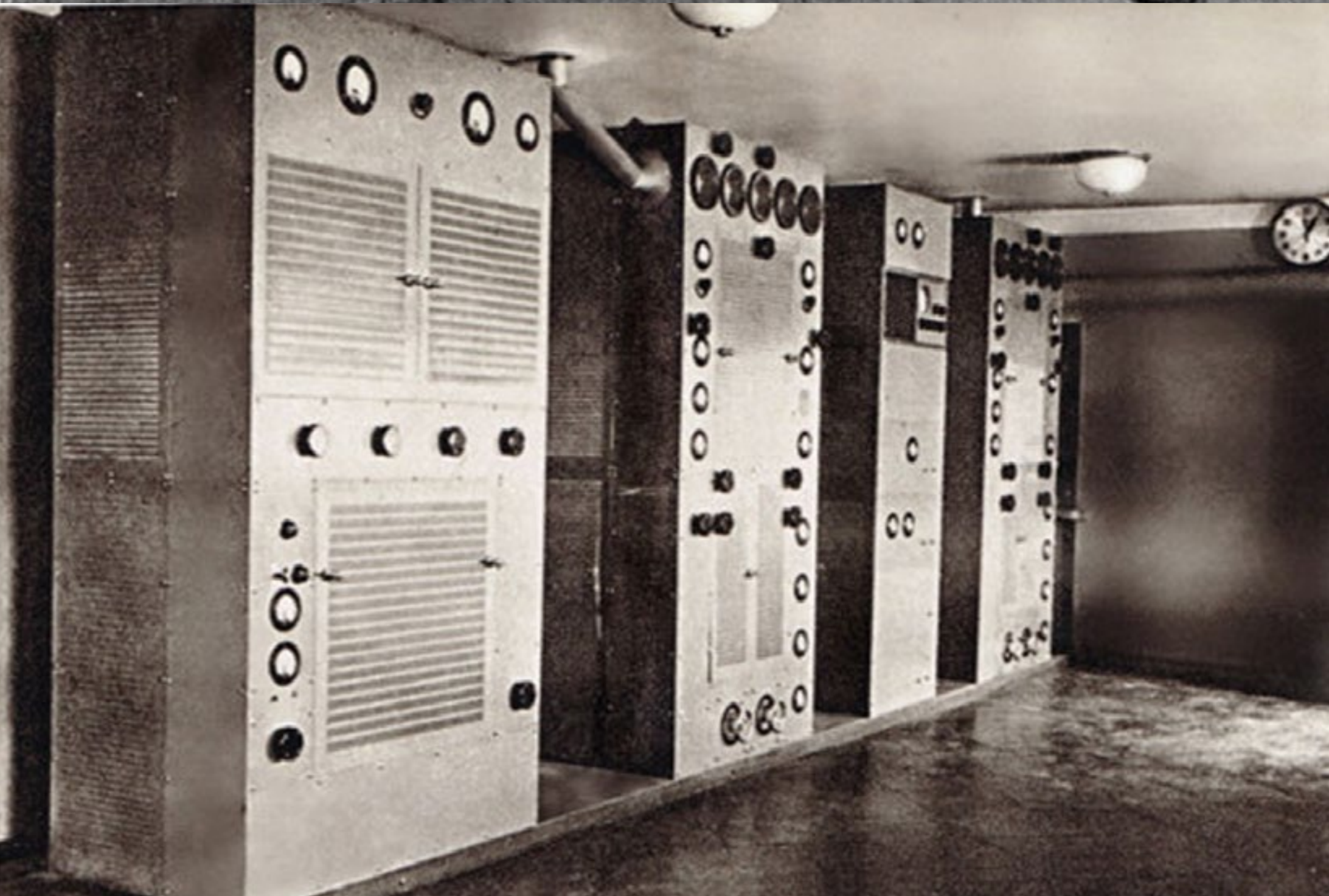
● Aparatura dla TV 343-liniowej, PIT, 1939 r.
