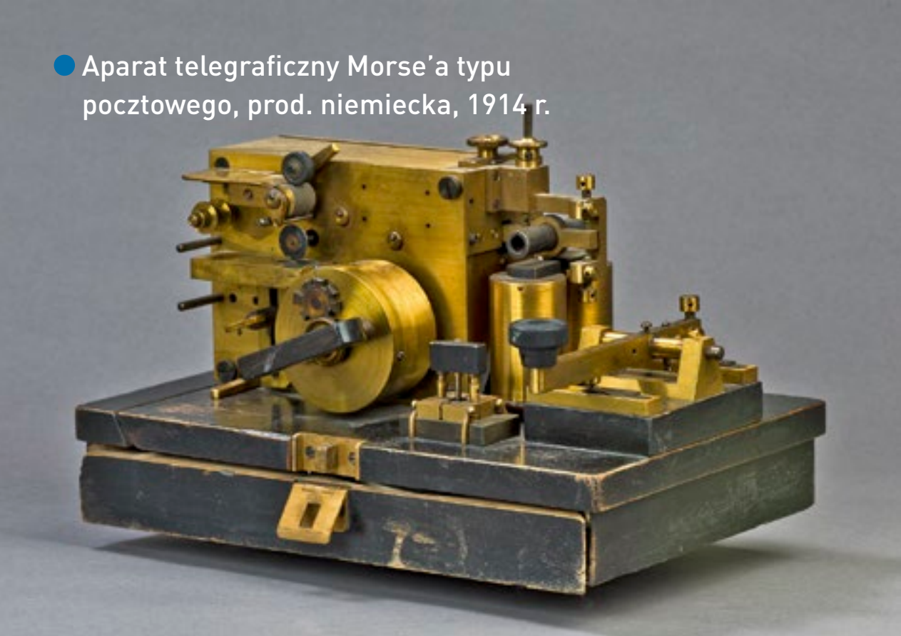
● Aparat telegraficzny Morse'a typu pocztowego, prod. niemiecka, 1914 r.
